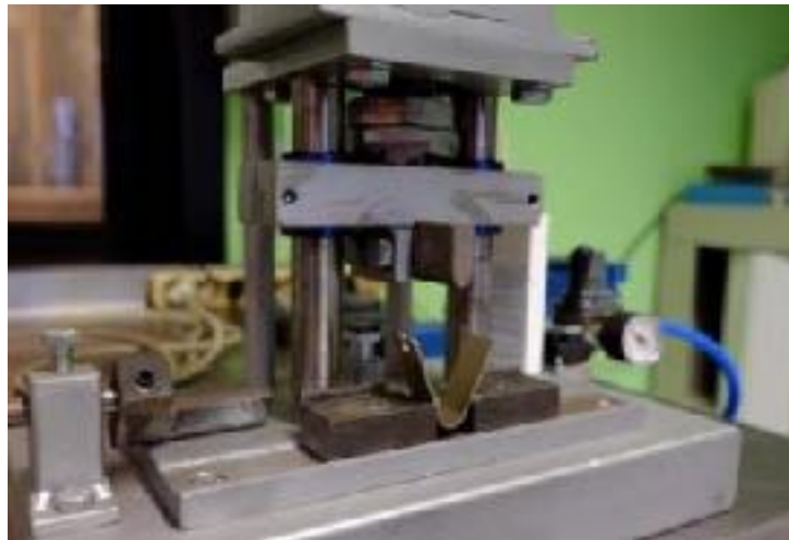
Bonding test according to ASTM B571 PAR 3
